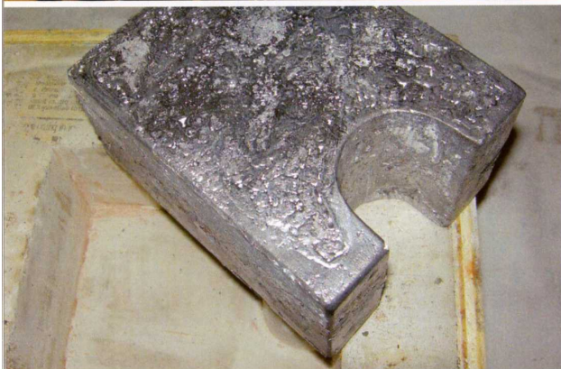
Realizzazione dei pani di piombo in aggiunta al contrappeso
