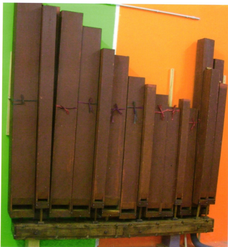
Le canne lignee originali dei Controbassi in laboratorio durante il restauro, montate sul somiere supplementare per la verifica
