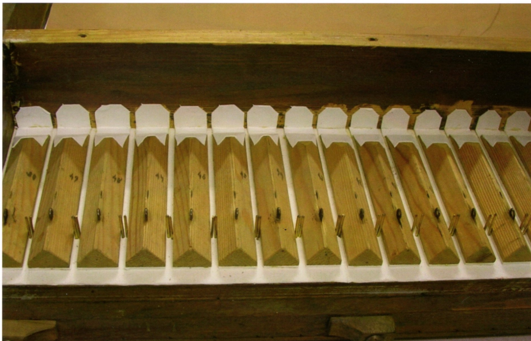
Il somiere maestro durante il restauro: i ventilabris sono ricollocati sui canali e guarniti con nuovo pellame
