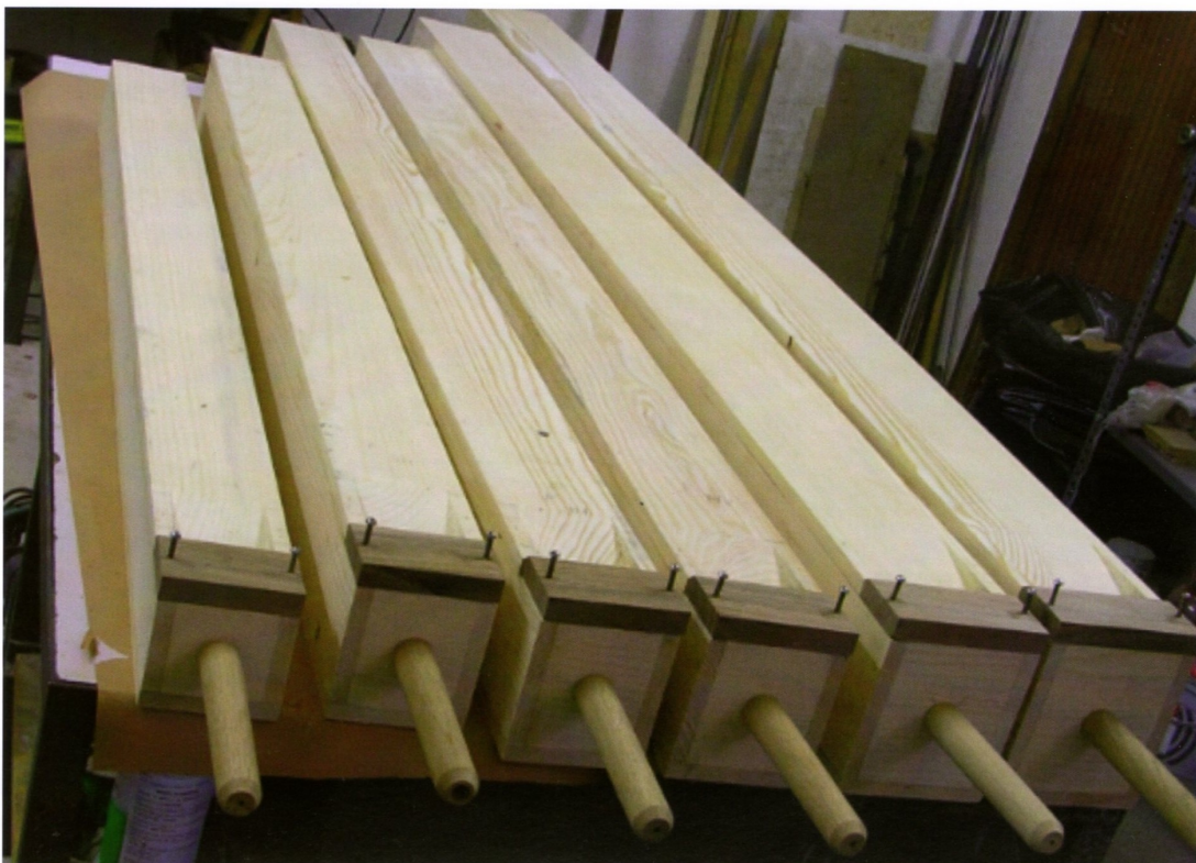
Le prime sei canne di legno del Principale Bassi durante la fase di ricostruzione in laboratorio
