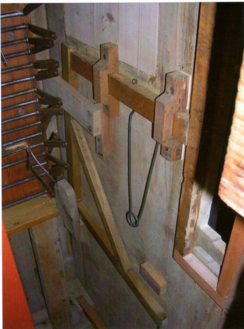
Tavola di riduzione della meccanica dei registri durante l'intervento: in corrispondenza dei catenacci, sono riportati a penna, su una striscia di carta applicata al bordo superiore e sul bordo destro, le indicazioni originali dei nomi dei registri
