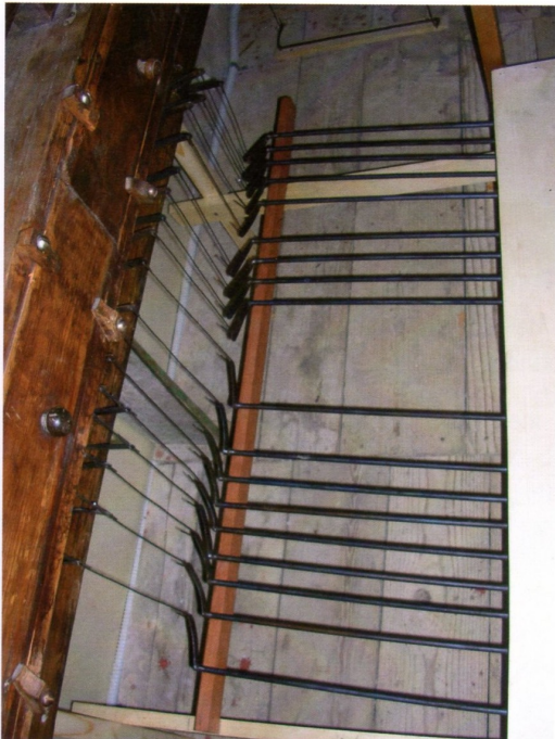
Tavola di riduzione della catenacciatura della tastiera dopo il restauro. In primo piano: i catenacci orizzontali in ferro e i tiranti verticali d'ottone. Sul bordo inferiore della tavola, la numerazione a inchiostro originale
