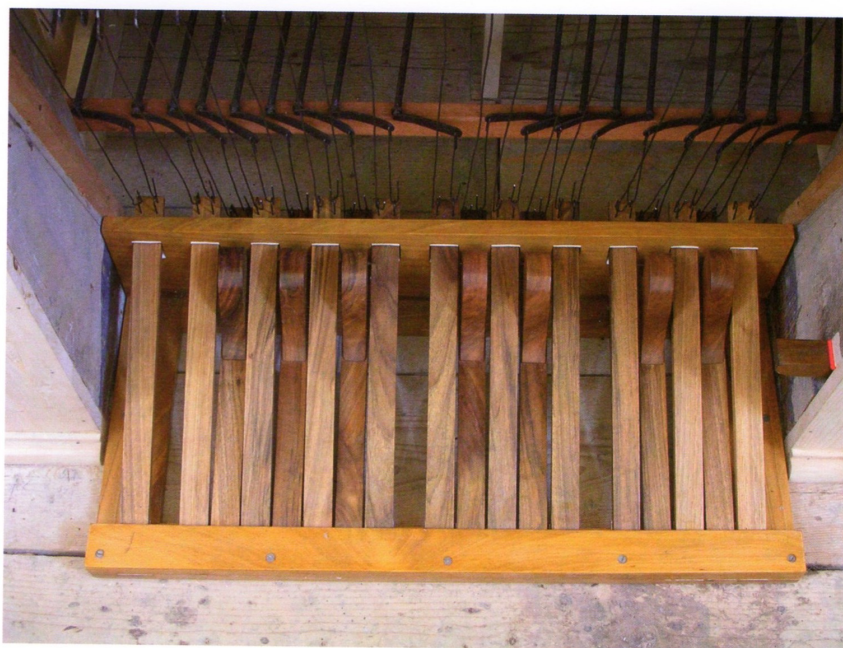
La pedaliera di noce e la relativa meccanica di trasmissione (ricostruite durante il restauro); sulla destra il pedaletto di comando della Combinazione preparabile 'alla lombarda'
