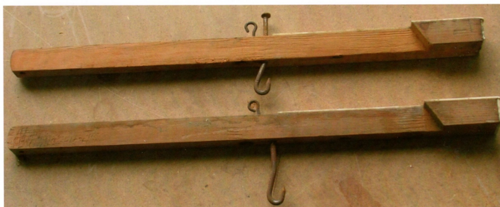
Particolare delle leve dei tasti (fianco sinistro) durante il restauro: al centro, l'occhiello e il gancio in ferro per il collegamento ai tiranti della meccanica
