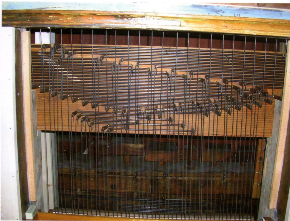
Tavola di riduzione della catenacciatura della tastiera dopo il restauro. In primo piano: i catenacci orizzontali in ferro e i tiranti verticali d'ottone. Sul bordo inferiore della tavola, la numerazione a inchiostro originale
