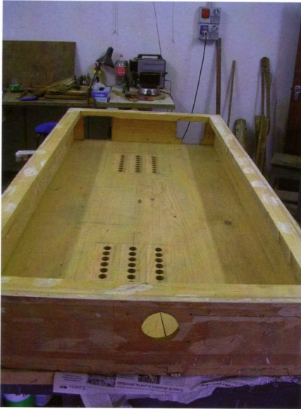
Il mantice a lanterna scomposto in laboratorio durante il restauro
