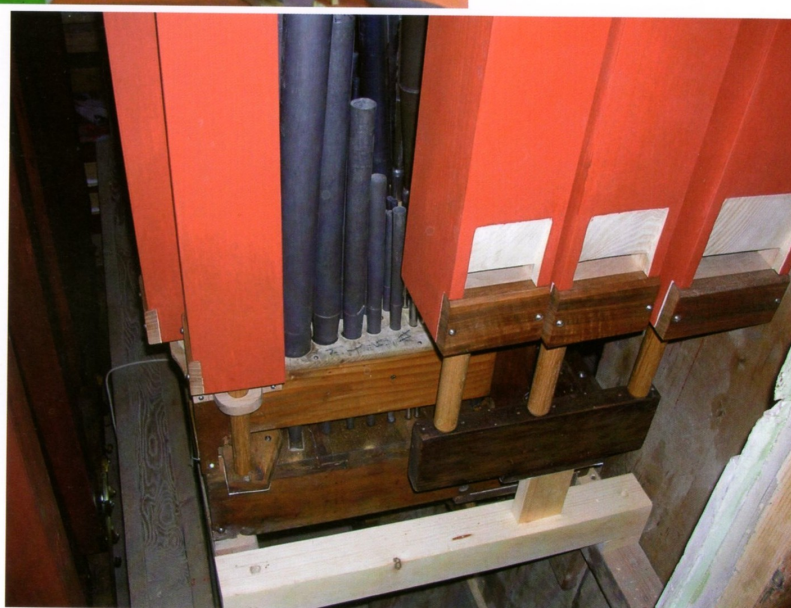
Le canne di legno del Principale e dell'Ottava (ricostruite) ricollocate sul somiere maestro durante la fase di montaggio dello strumento
