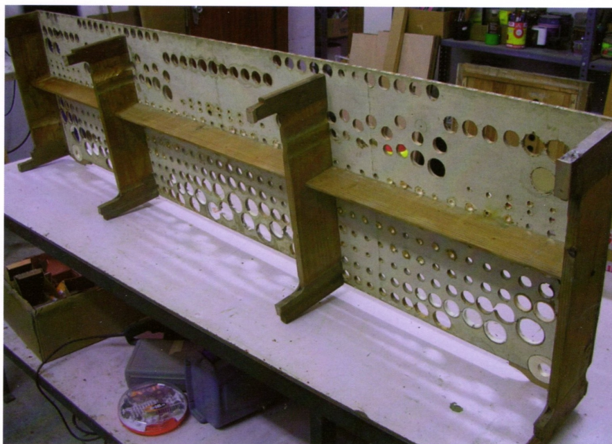
Il crivello restaurato in laboratorio: sulla superficie inferiore del piano d'abete si notano le rettifiche effettuate ai diametri dei fori
