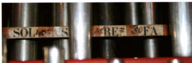
Canne di stagno del Flautino Bassi di 1' e dell'Ottavino Soprani di 2' (ricostruite) riposizionate alla base del prospetto
