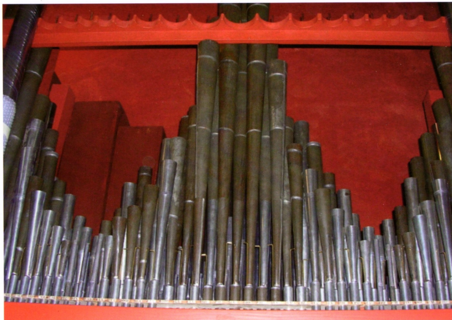
Canne interne in fase di montaggio: in primo piano le tube coniche della Tromba Bassi e Soprani di 8'
