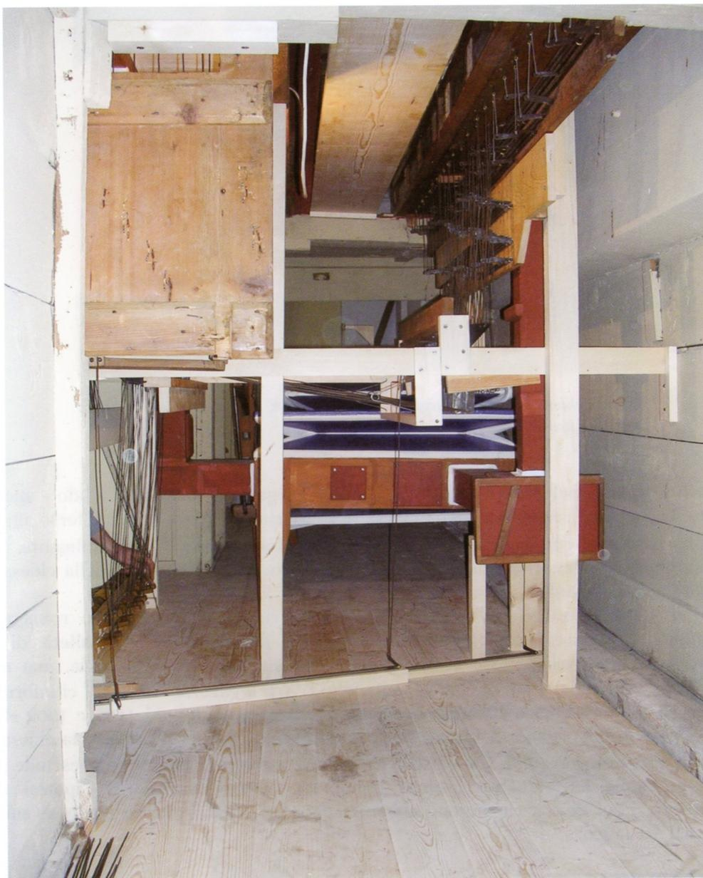
*Interno dell'organo (da sinistra a destra): la pedaliera (in basso), la tavola della catenacciatura dei registri, il mantice e i condotti del vento, la tavola del 'passo d'uomo' (in alto) e le tavole di catenacciatura del somiere di basseria*
