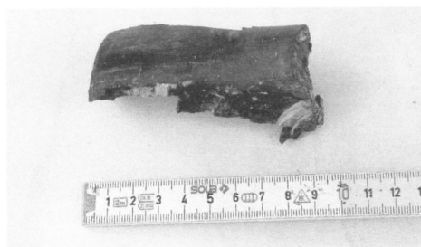
Particolare della scheggia di ordigno bellico penetrata all'interno dell'organo
