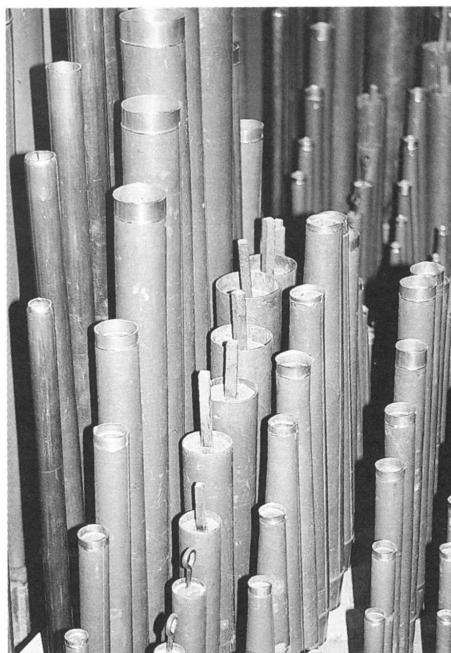
Le canne interne dopo il restauro: si notino gli allungamenti dei corpi
