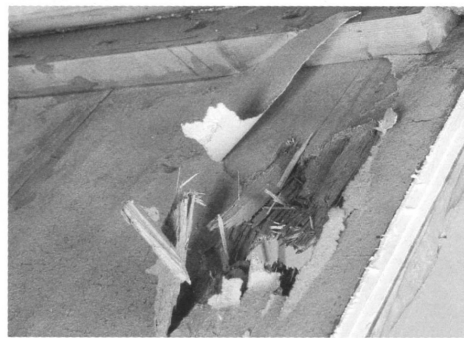
Il mantice originale prima del restauro: in primo piano il foro d'entrata della scheggia
