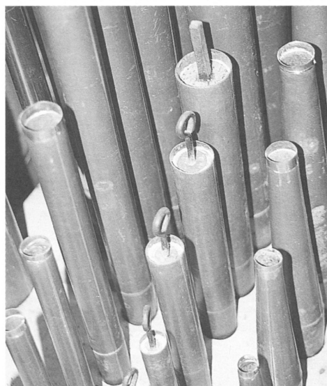
Particolare delle canne interne del Flauto in ottava e del Flauto in duodecima dopo il restauro
